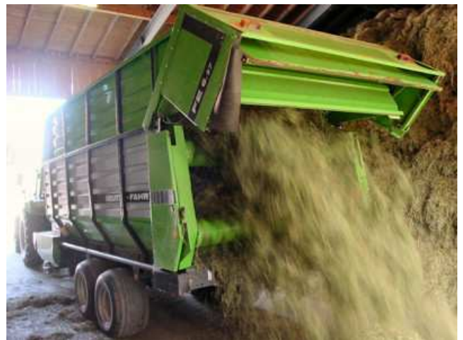
Bild 12: Abladen und Lockern mit dem Dosierladewagen
